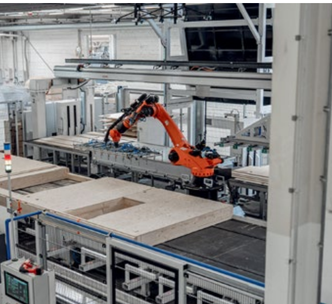
Die Bauteile für ein Fertighaus werden industriell im Werk vorgefertigt und dann in kurzer Zeit auf dem Baugrundstück montiert.
