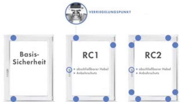
Die Sicherheitspunkte an Fenstern: Ein Standardfenster hat lediglich zwei Verriegelungspunkte, einbruchhemmende dagegen vier oder mehr Pilzköpfe. Zudem enthalten sie einen Anbohrschutz.
