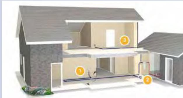
auch für Allergiker. „Luftströme und die höhere Saugleistung sorgen beim Saugen dafür, dass Schmutz- und Feinstaub nicht aufgewirbelt werden. Sie werden effektiv in den Sammelbehälter befördert und hier mit oder ohne Beutel aufgefangen. Feinste Stäube werden ins Freie geblasen“, sagt SaugVec-Inhaber Horst-H. Bessert. Der Experte empfiehlt eine Planung anhand der Grundrisspläne. Diesen Service sowie die Installation übernimmt SaugVec.HO
