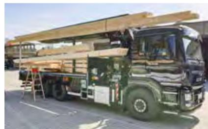
Bei Bedarf arbeitet MKG in enger Zusammenarbeit mit dem Betreiber ein passendes Konzept aus. Das leichte, jedoch sehr stabile Armprofil sorgt für eine punktgenaue Montage von Pfetten und weiterem Dachstuhlmaterial auch unter schwierigen Bedingungen. Alle Krane verfügen serienmäßig über eine Funkfernsteuerung und werden mit Schnelllaufwinden ausgerüstet. HO
