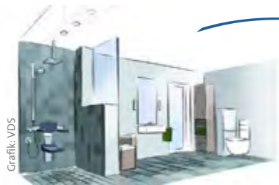
Barrierefreie Bäder punkten im Detail: bodengleiche Dusche mit Klappsitz, unterfahrbare Waschtisch und WC mit Stützklappgriff. Das alles ist nicht nur praktisch, sondern wird im modernen Bad auch formschön umgesetzt
