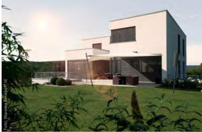
Ein heller, außenliegender Sonnenschutz sorgt dafür, dass das Sonnenlicht reflektiert wird und die Wärme erst gar nicht ins Haus kommt.
