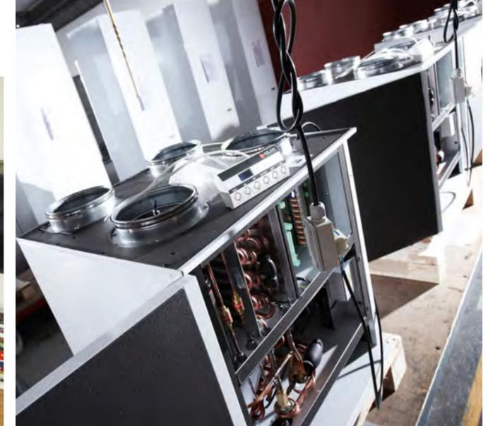
Ein Wärmerückgewinnungsaggregat während der Produktionszeit bei Nilan
