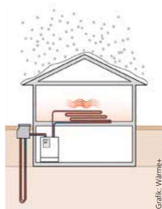
Eine Wärmepumpe nutzt die Umweltwärme des Erdreichs zum Beheizen der Wohnräume
